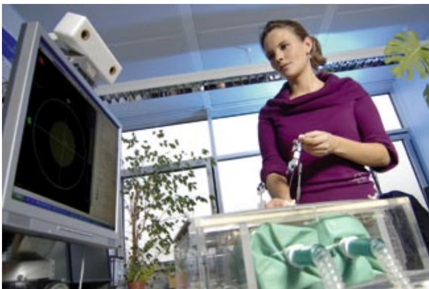
Lena Maier-Hein testet ihre Erfindung. Das computergesteuerte Zielsystem zeigt Ärzten an, wie sie ihre Hitzennadeln einstecken müssen, um Lebermetastasen treffsicher zu zerstören.
