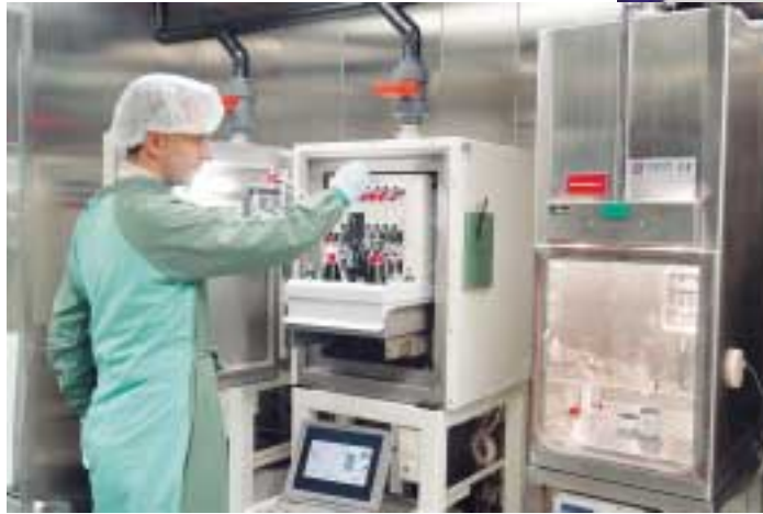
Die Radionuklide werden in einem speziellen Labor verarbeitet, um Verunreinigungen zu vermeiden (links). Bild oben: Der im Krebsforschungszentrum entwickelte Generator zur Herstellung von Gallium-68. Ganz rechts: eine Vakuumpumpe sorgt für einen ungebremsten Flug der Teilchen im Zyklotron.
