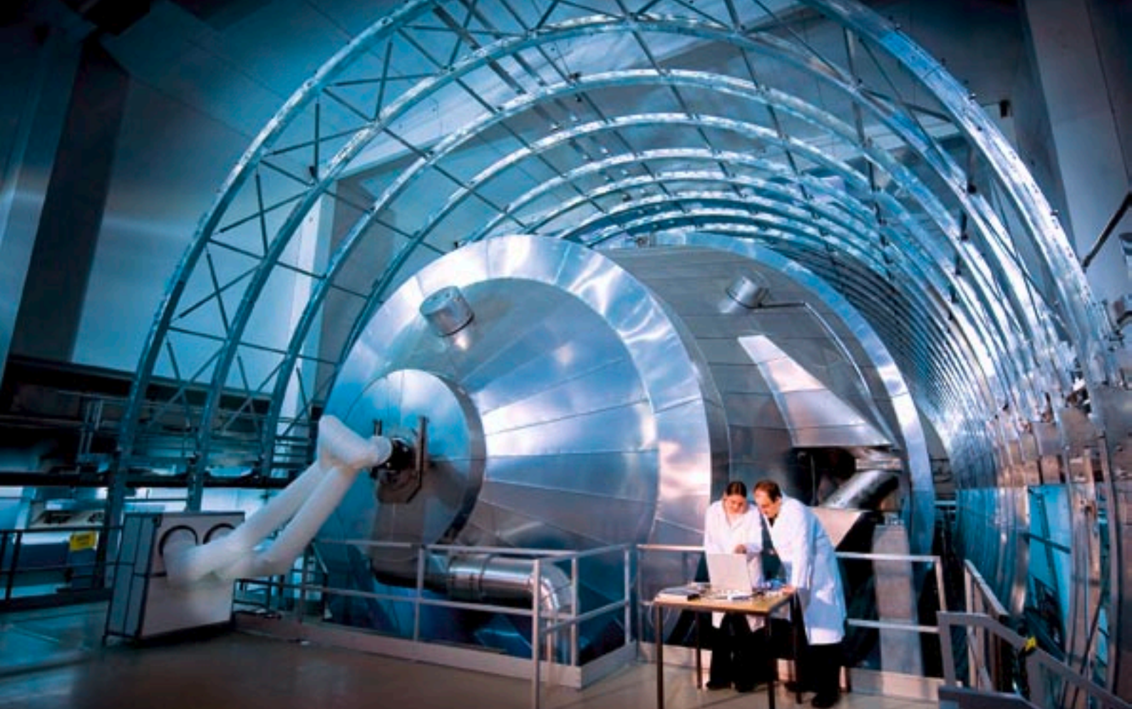
Zwei Forscher vom KIT überprüfen das Experiment „Katrin“. Der gewaltige Aufbau dient dazu, die Masse des Neutrinos zu bestimmen, des zweithäufigsten Elementarteilchens im Universum.
