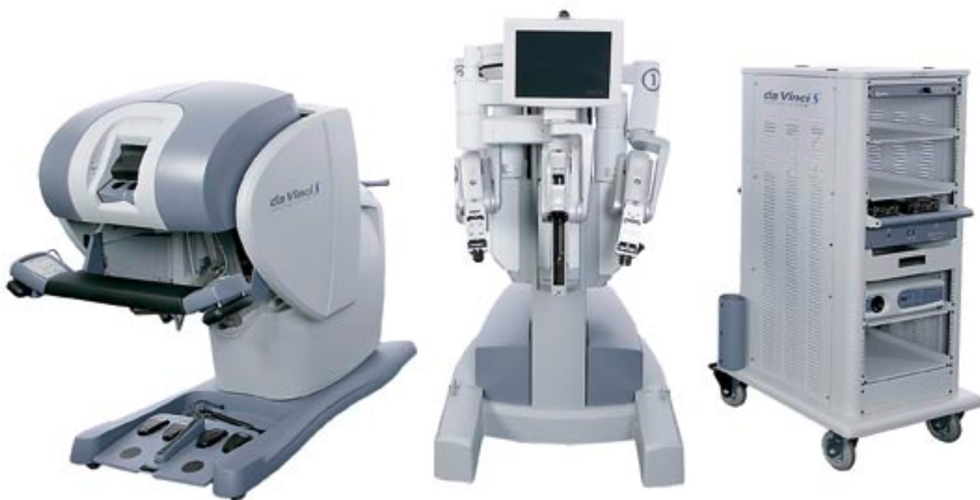
Das Da-Vinci-Operationssystem besteht aus drei Teilen: Vom Steuerpult aus (links) lenkt der Arzt die Bewegungen des eigentlichen OP-Roboters (Mitte). Auf dem „Vision Cart“ (rechts) stehen während der Operation unter anderem Bildschirme für die Assistenzärzte.
