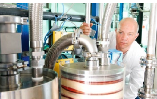
Dr. Torsten Brinkmann konstruiert am Institut für Polymerforschung Bauelemente, mit denen sich Gase trennen lassen. Dafür verwendet er neu entwickelte Membranen aus Geesthacht.
