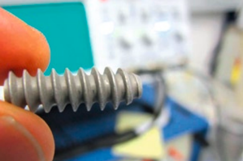
An Bord der „Ludwig Prandtl“ erforschen Mitarbeiter des Helmholtz-Zentrums Geesthacht den Einfluss des Klimawandels auf den Nord- und Ostseeraum (Bild rechts). Zu Lande entwickeln sie unter anderem neue Schweißverfahren (Bild oben links) oder Schrauben aus Magnesium, die sich im Körper auflösen können (Bild unten links).
