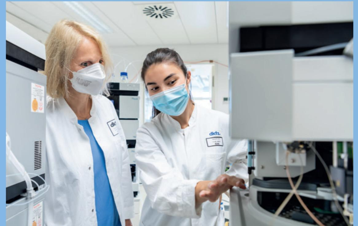
Eines der wichtigsten Werkzeuge in der Abteilung von Ursula Klingmüller ist die Massenspektrometrie. Mit dieser Technologie lässt sich zum Beispiel untersuchen, welche Proteine die Zellen unter bestimmten Bedingungen herstellen.
