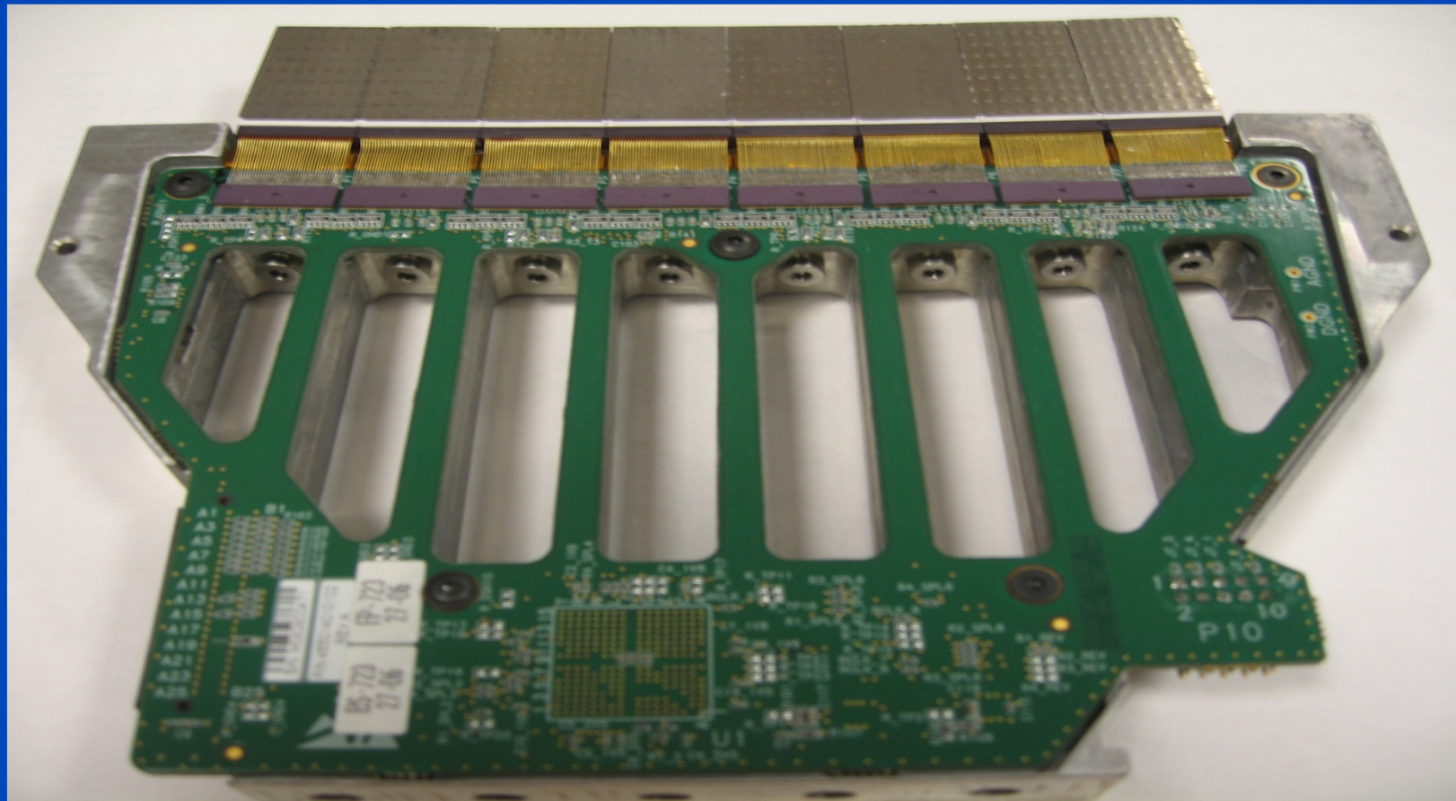
„Nanopanel-Detektoren“, modular und 2D kachelbar, vollfokussiertes 2D Streustrahlraster, Anordnung auf Kugeloberflächensegment (Photo courtesy by Philips)
