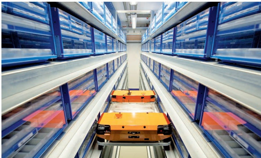
Abb. 2: Blick auf das neue Regalsystem der Biobank Graz mit einem AIV (automatischem intelligenten Vehikel) und den eigens für die Biobank entwickelten Lagerungsboxen in den Regalen
